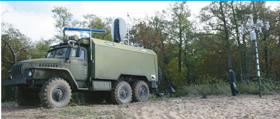
Автоматизированный подвижный комплекс контроля воздушного и морского пространства прибрежной зоны. Automated mobile system for monitoring of the air and sea situation in the littoral area
