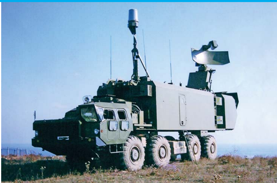
Машина боевого управления БРК «Бал-Э» с выдвинутыми антеннами РЛС ЦУ Target designation radar Bal-E with pulled-out antennas
